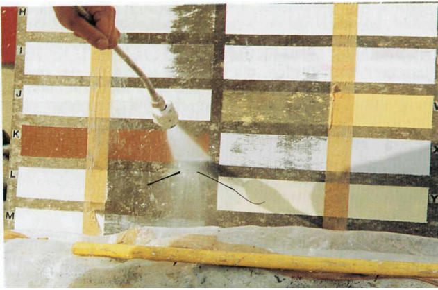
Abstrahlen mit geringem Wasserdruck.
